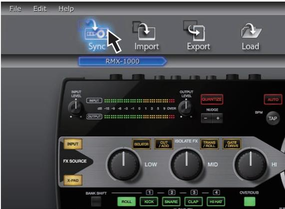
Die benutzerangepassten Parameterdaten werden in den RMX-1000 geladen.
