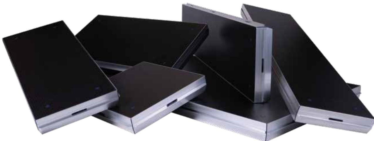
Bestseller ist das Systempodest 200 x 100 cm, Art.Nr. 111 01 0, mit einem Gewicht von ca. 33 kg und dem Standardrahmen aus 2 Feder- und 2 Nutprofilen. Die Standardbreiten sind 200 cm, 150 cm, 100 cm, 75 cm und 50 cm. Die Standardtiefen lauten 100 cm, 75 cm und 50 cm. Alle Zwischenmaße sind möglich, sofern 200 cm in der Breite und 100 cm in der Tiefe nicht überschritten werden. Auch abweichende Rahmenkonfigurationen wie umlaufendes Nutprofil sind möglich.
