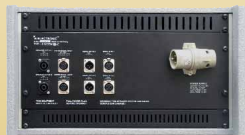
Rückseite Verstärkerrack mit Anschlusspanel Backside amplifier rack with connector panel
